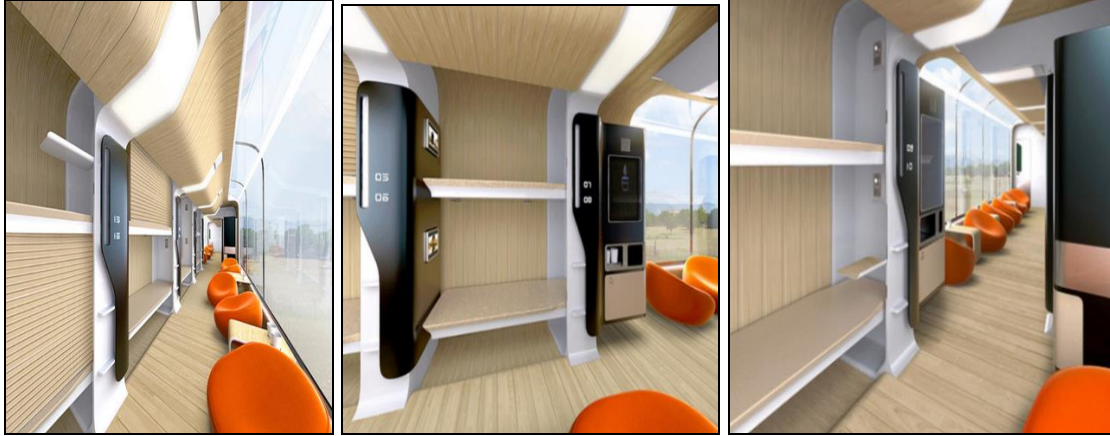
شكل : (13) يوضح التصميم الداخلي لعمارة قطار للمصمم أندري شيركوف من تنفيذ شركة بومباردييه المصنوعة من الأخشاب ولكن عن طريق تكنولوجيا تشكيل الأخشاب
